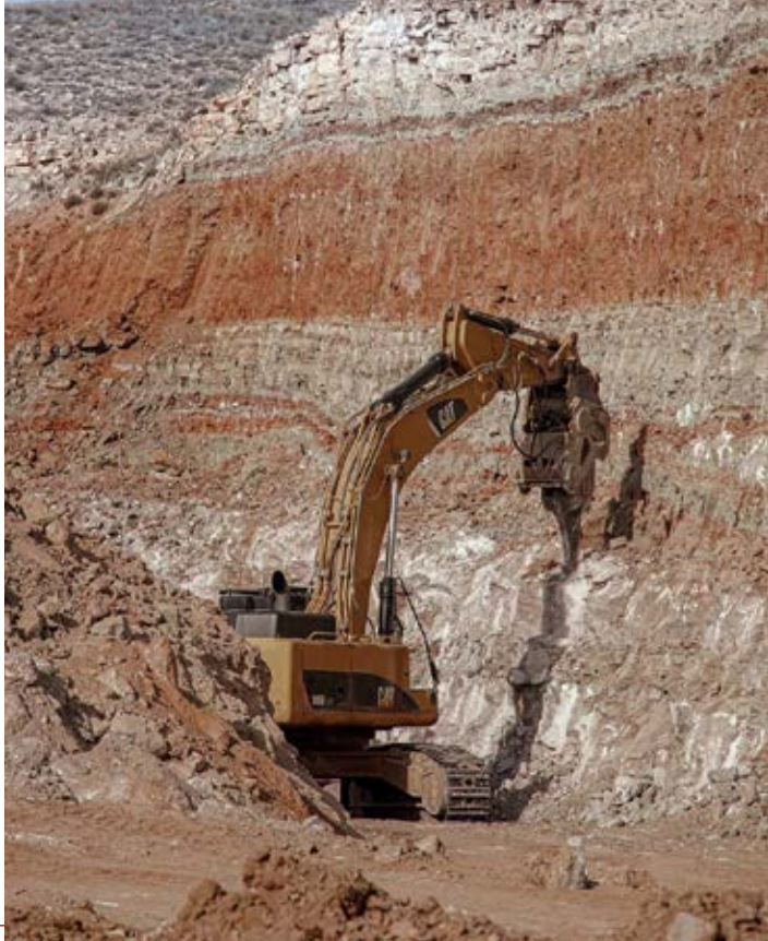
Figura 2. Máquina en la explotación extrayendo alabastro. Fuente: Tisure + D. Escriche
